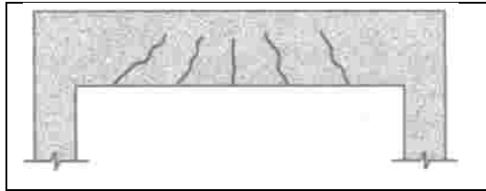
Figura 6-4. Pandeo y fisuras en viga 13
