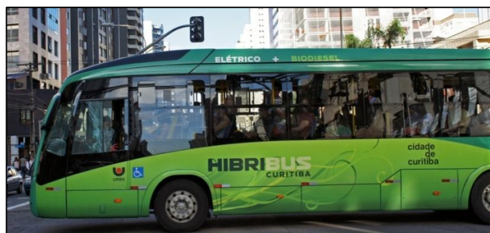
Figura 11. Autobús híbrido (biodiesel-eléctrico) fabricado por la empresa Volvo, presta el servicio de alimentador en la RIT.
