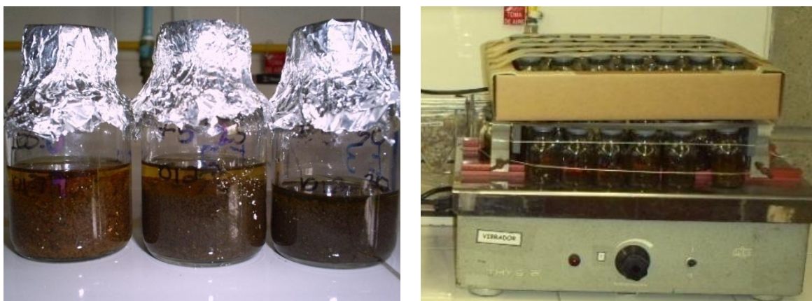
Figura 13. Proceso extractivo para la recuperación de los pesticidas
