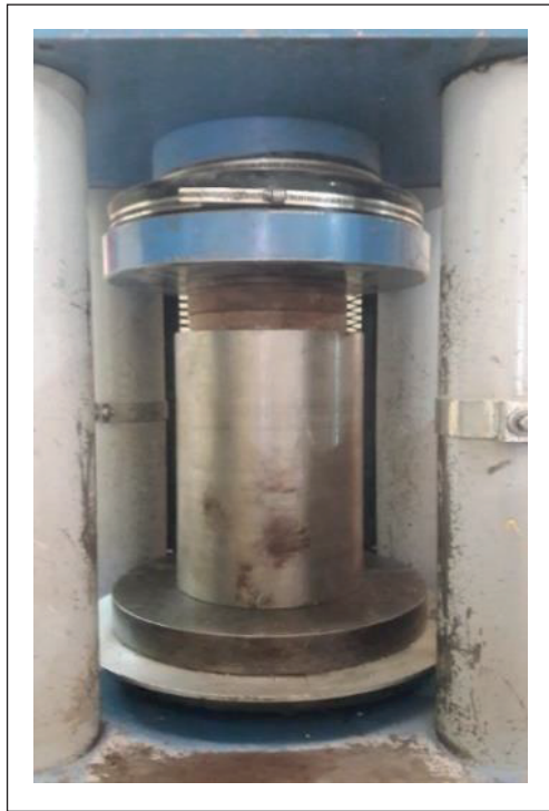
Figura 23.4. Aplicación de la sobrecarga para la compactación del espécimen de suelo mezclado con cemento
