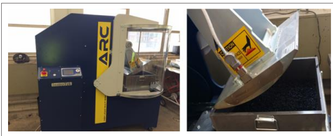
Figura 15.4. Compactador ARC y mezcla asfáltica suelta en la primera capa a 127 °C antes de la compactación de la primera loseta
