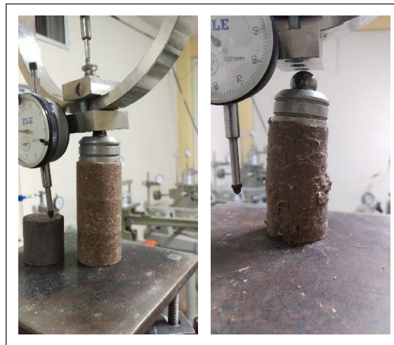
Figura 22.4. Proceso de ensaye de UCS
