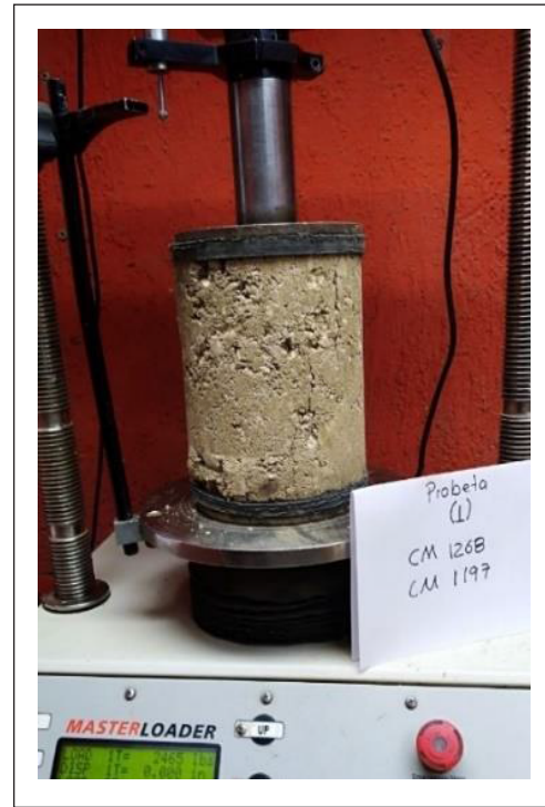
Figura 23.5. Ejecución ensayo de resistencia a la compresión confinada en especímenes de suelo mezclado con cemento
