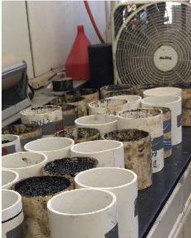
Figura 10.3. Moldes de PVC y especímenes mezclas abiertas
