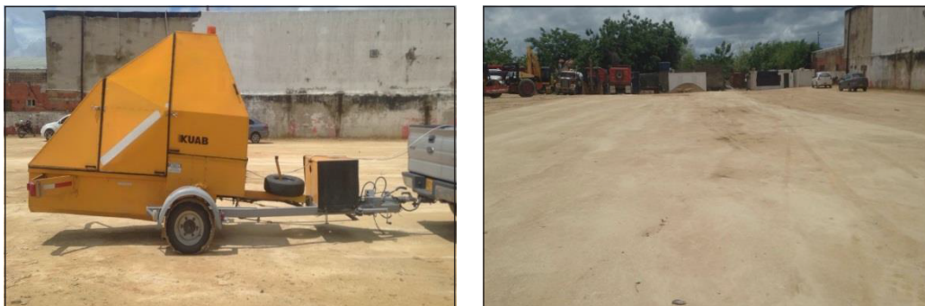
Figura 25.12. Mediciones con FWD sobre capa de suelo cemento. Parqueadero Santo Tomás
