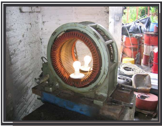
Ilustración 5: Reparación de embobinado de un motor.
