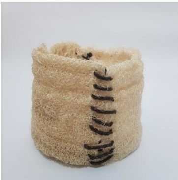
Ilustración 22. Prototipos de baja fidelidad en estropajo (Fuente propia). Se cortaron las piezas de estropajo y se utilizó un elemento de transición, en este caso el hilo trenzado para formar la geometría propuesta, dado a que tanto en el material del nopal como del estropajo no es posible obtener de una sola pieza la geometría completa.
