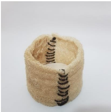
Ilustración 22. Prototipos de baja fidelidad en estropajo (Fuente propia). Se cortaron las piezas de estropajo y se utilizó un elemento de transición, en este caso el hilo trenzado para formar la geometría propuesta, dado a que tanto en el material del nopal como del estropajo no es posible obtener de una sola pieza la geometría completa.
