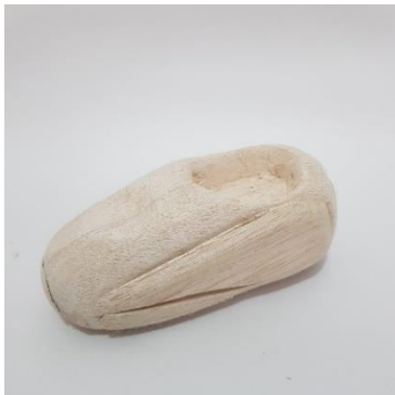
Ilustración 22. Prototipos de baja fidelidad en estropajo (Fuente propia). Se cortaron las piezas de estropajo y se utilizó un elemento de transición, en este caso el hilo trenzado para formar la geometría propuesta, dado a que tanto en el material del nopal como del estropajo no es posible obtener de una sola pieza la geometría completa.
