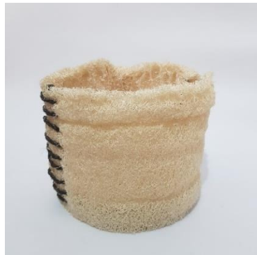
Ilustración 22. Prototipos de baja fidelidad en estropajo (Fuente propia). Se cortaron las piezas de estropajo y se utilizó un elemento de transición, en este caso el hilo trenzado para formar la geometría propuesta, dado a que tanto en el material del nopal como del estropajo no es posible obtener de una sola pieza la geometría completa.
