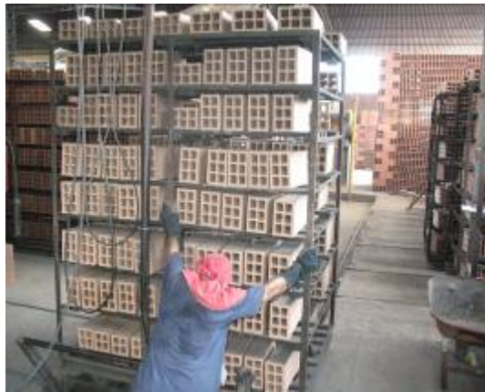
Foto 15. Cargue de vagonetas
