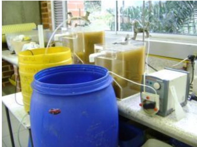
Figura 29 Montaje de reactores en paralelo de la primera fase. R2 a la izquierda y R1 a la derecha
