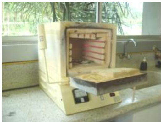
Figura 19 Mufla para incineración de los sólidos
