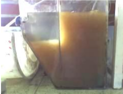
Figura 2 Reactor aerobio mezcla completa.
