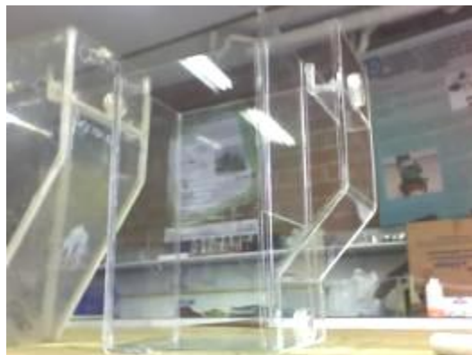
Figura 16 Recipiente de acrílico (Reactor)
