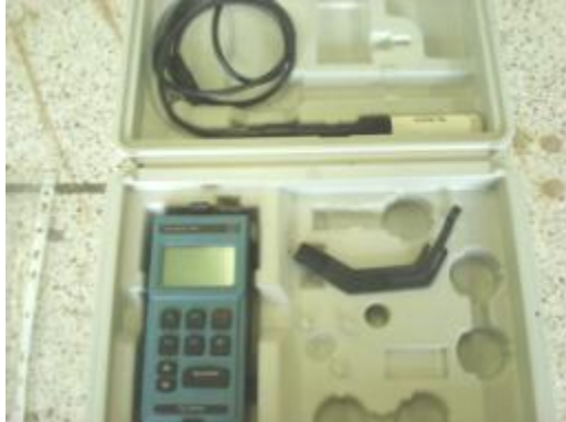
Figura 22 Oxímetro Handylab OX1 de Schott para medición de OD
