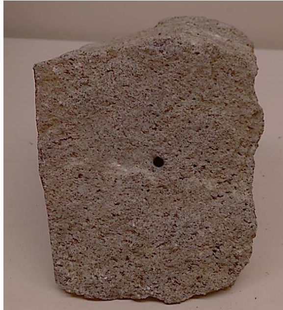
Figura 4: Perforación de 4 mm de diámetro para la medición de la conductividad térmica.
