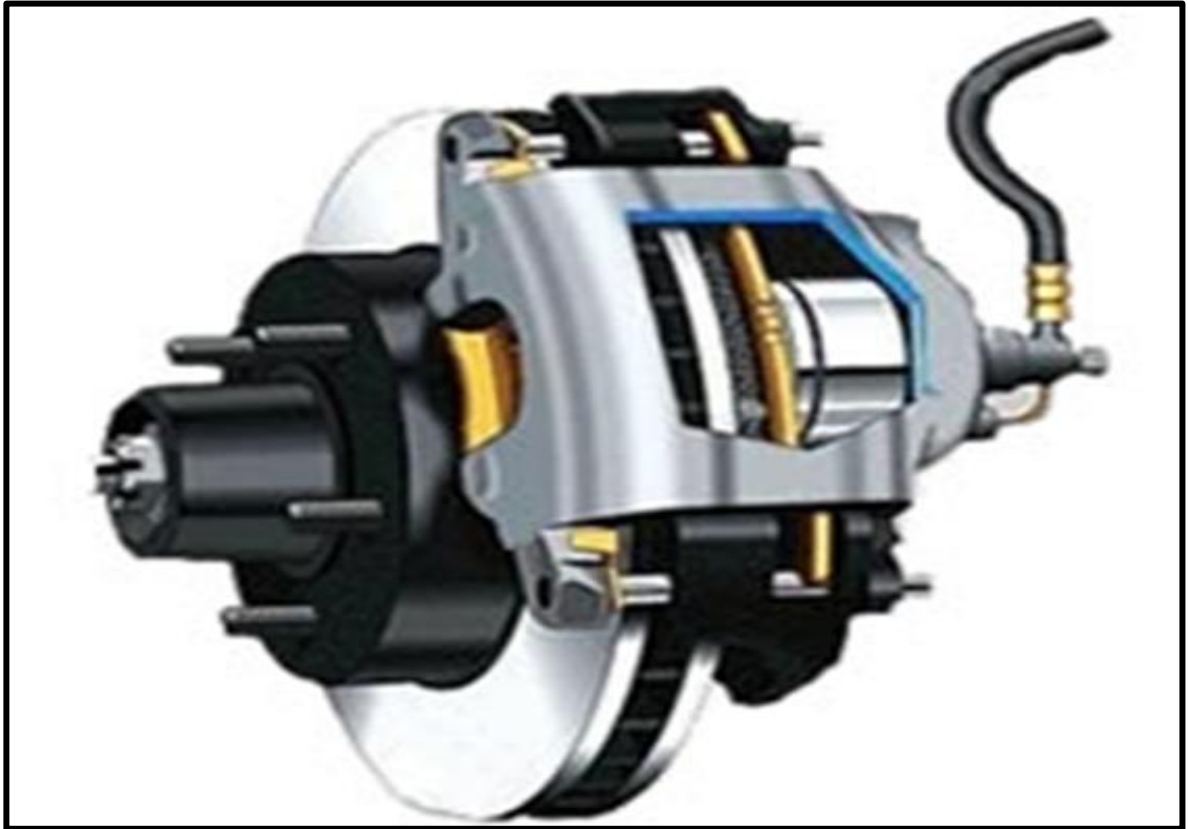
Imagen 9. Vista superior del sistema de frenos de disco
