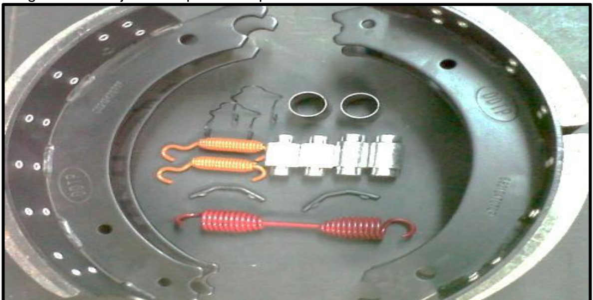
Imagen 5. montaje de bloques en zapata
