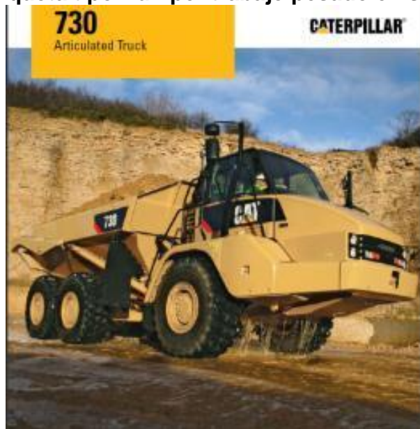
Fotografía 43. Volqueta tipo Dumper trabajo pesado en sitios muy agrestes
