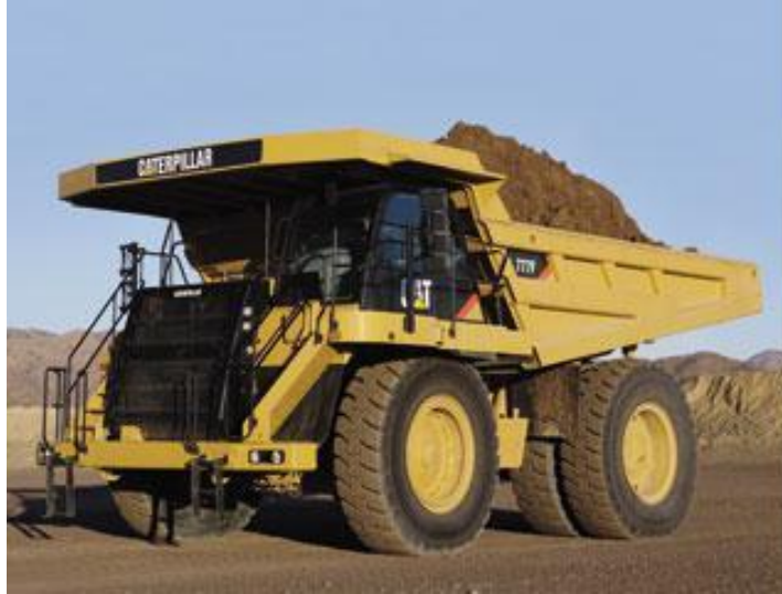
Fotografía 42. Volqueta Minera con capacidad de 30 a 50m 3
