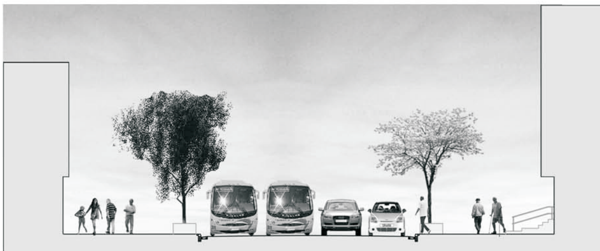
Fotografía 12 Sección vial Actual, cuatro carriles.
