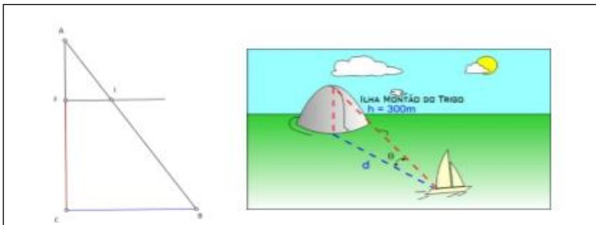
**Figura 2.** Cálculo de la distancia de una nave a la costa con la ayuda de un razonamiento proporcional realizado por Thales de Mileto (Daza, 2014, p. 26).
