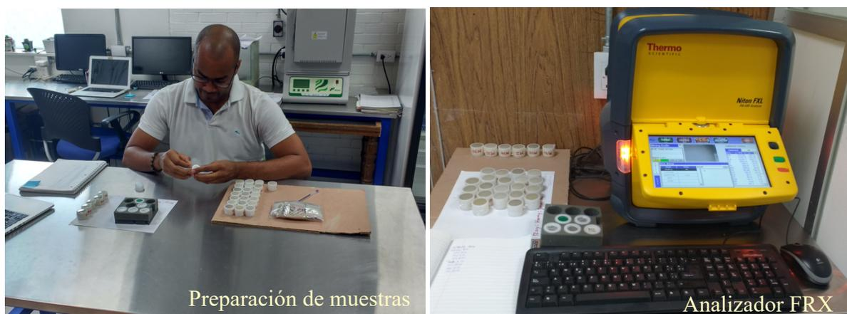
Figura 3-12. Medición de las concentraciones totales de elementos mayores y traza en el Laboratorio de Paleoambientes y Paleoclimas, Instituto de Geología, UNAM
