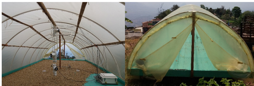
Figura 1. Estructura del secador solar tipo túnel
