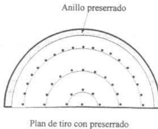
Imagen 29. Preserrado en rocas duras (explosivo).
