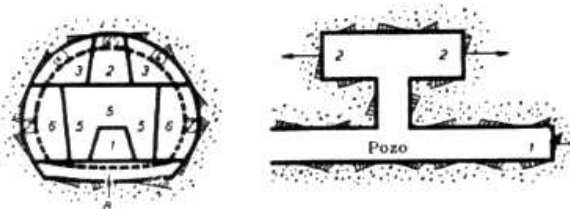
Método de las dos galerías. 1, galería de base; 2, galería de coronación; 3, excavación de la bóveda; 4 y 4', bóveda; 5, destroza; 6, excavación de los muros; 7, muros; 8, solera (eventualmente).
