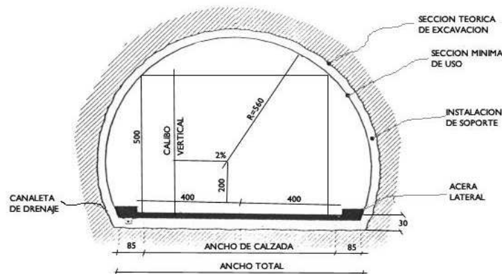
Imagen 5. Sección transversal de un túnel de carretera.
