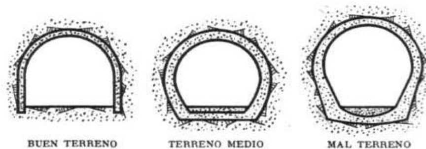
Imagen 4. Secciones transversales de túneles para vías férreas.
