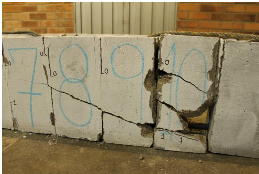
Figura 3.15: Reconstrucción de la viga 18 tras la falla
