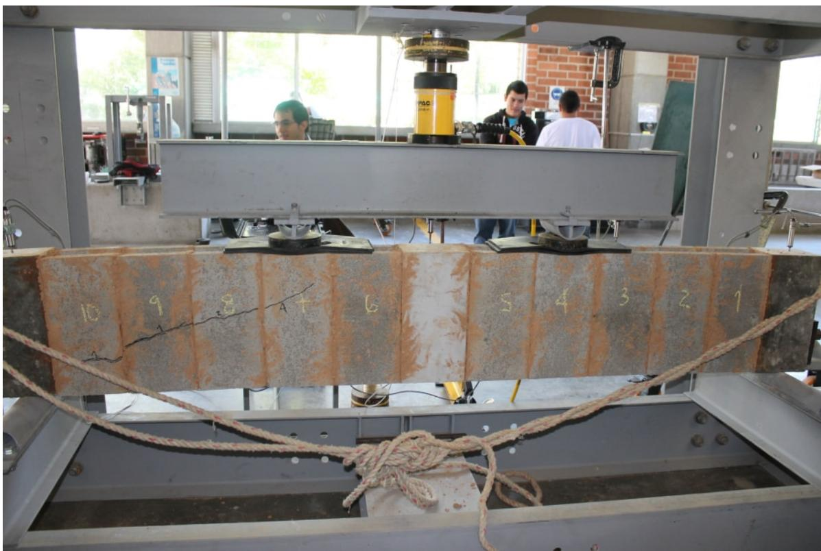
Figura 3.7: Instante de la falla de la viga 2, cara posterior
