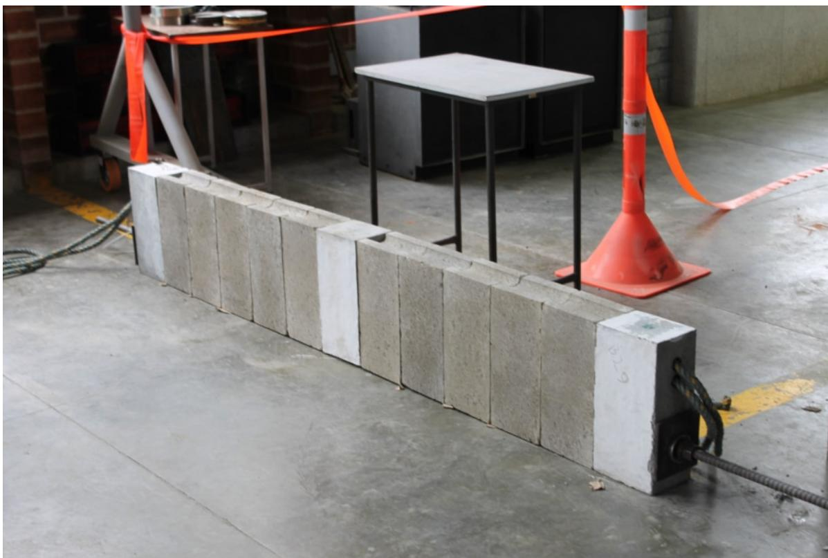
Figura 3.2: Configuración general de vigas de mampostería con postensado excéntrico no adherido pertenecientes a la base de datos de García (2016)
