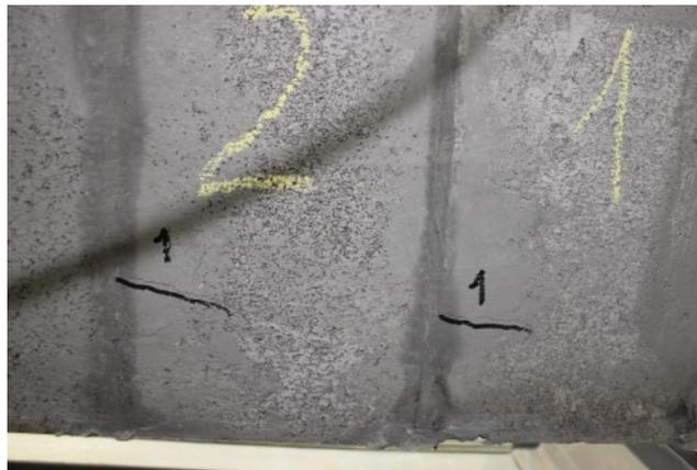
Figura 3.9: Primeras grietas de corte en el vano de cortante de la viga 6
