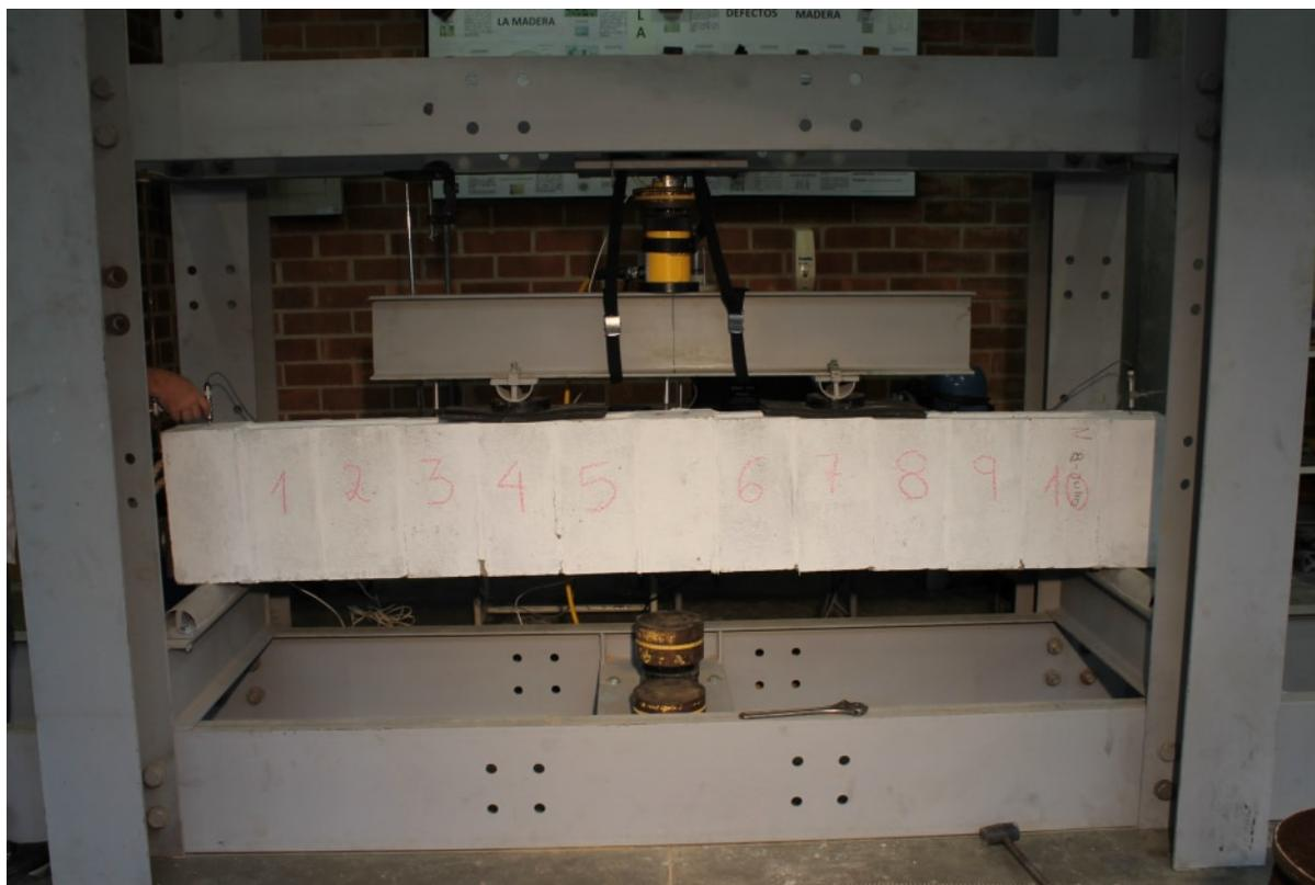
Figura 3.3: Configuración de ensayo monotónico de 4 puntos de contacto
