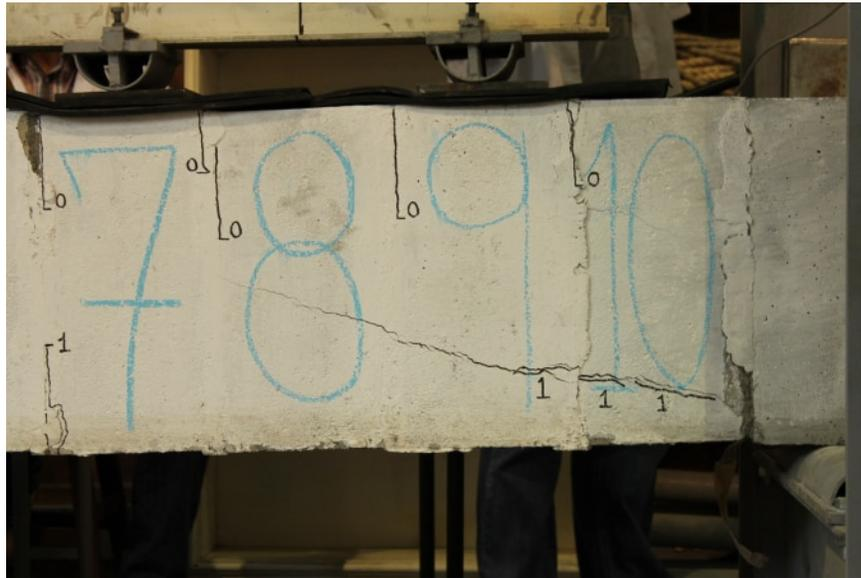
Figura 3.14: Enfoque del instante justo antes de la falla de la viga 18
