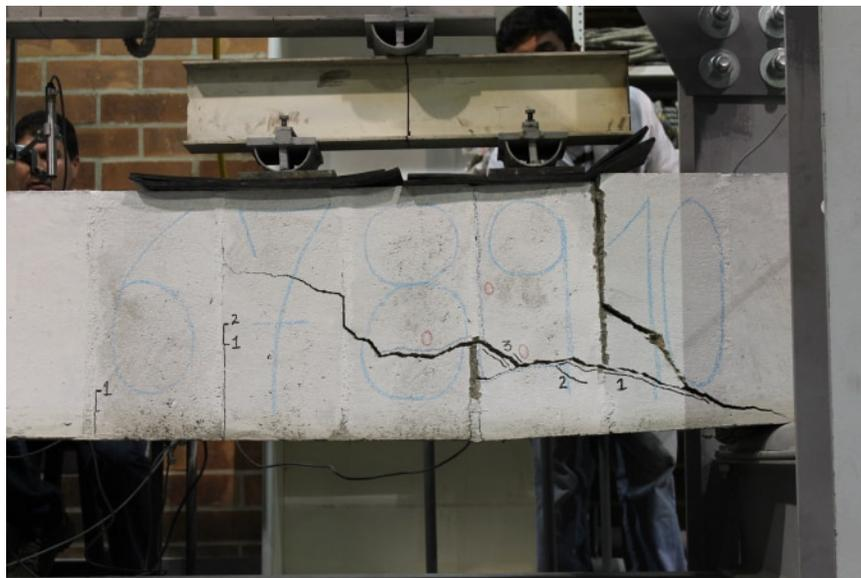
Figura 3.21: Enfoque del instante de la falla de la viga 20
