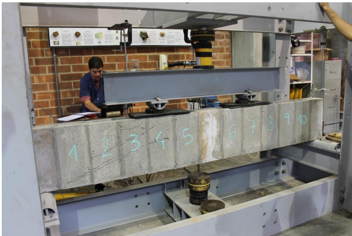
Figura 3.10: Instante de la falla de la viga 6
