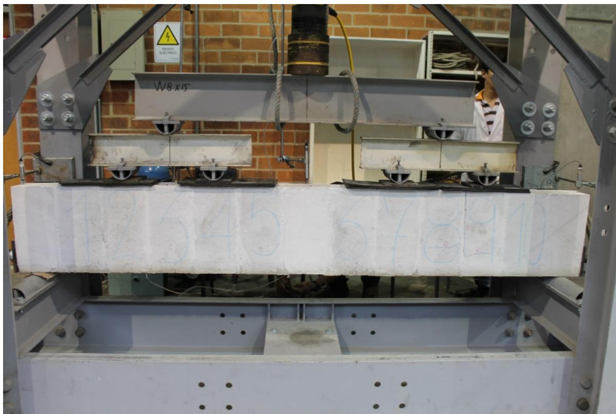
Figura 3.6: Configuración de ensayo monotónico de 6 puntos de contacto
