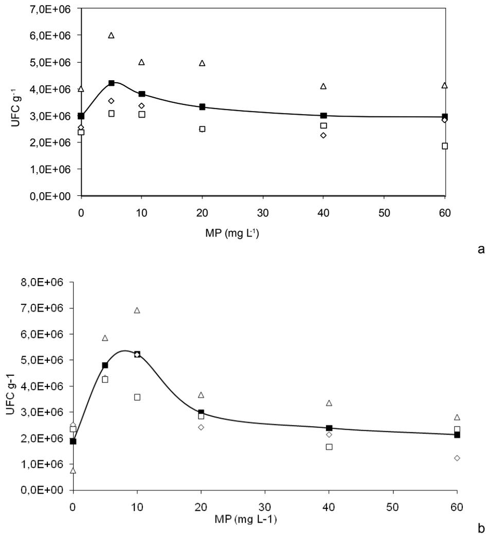
**Figura 2.** Variación de las UFC g<sup>-1</sup> de suelo agrícola fumigado con MP en medios enriquecidos con MP entre 0-60 mg L<sup>-1</sup> enriquecidos con EL. (a) 0.05 g L<sup>-1</sup> de EL. (b) con 0.5 g L<sup>-1</sup> de EL. Valores de las réplicas (□, ◇, △) y promedio (■).
