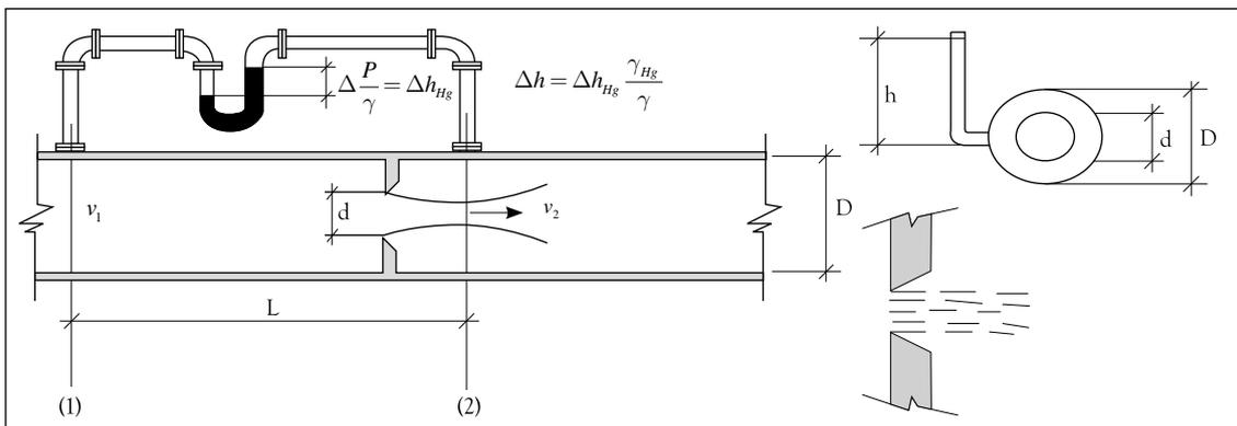
Figura 2. Reducción de orificio circular en tuberías
