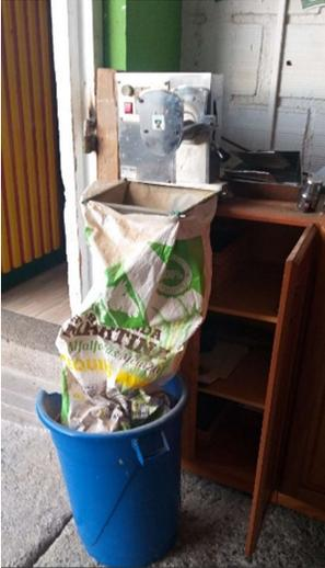
Trilladora de café, usada para remover la cascara del grano en pergamino o cereza seca (café natural) hasta transformarlo y clasificarlo de forma mecánica en café verde o excelso, dejando listo para ser exportado.
