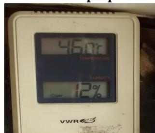
Debido a la temperatura, se perdía la humedad al interior de los recipientes, con el fin de mantener la humedad se ubicó una esponja húmeda en los recipientes, de esta manera se garantizaba una humedad cercana al 70%.
