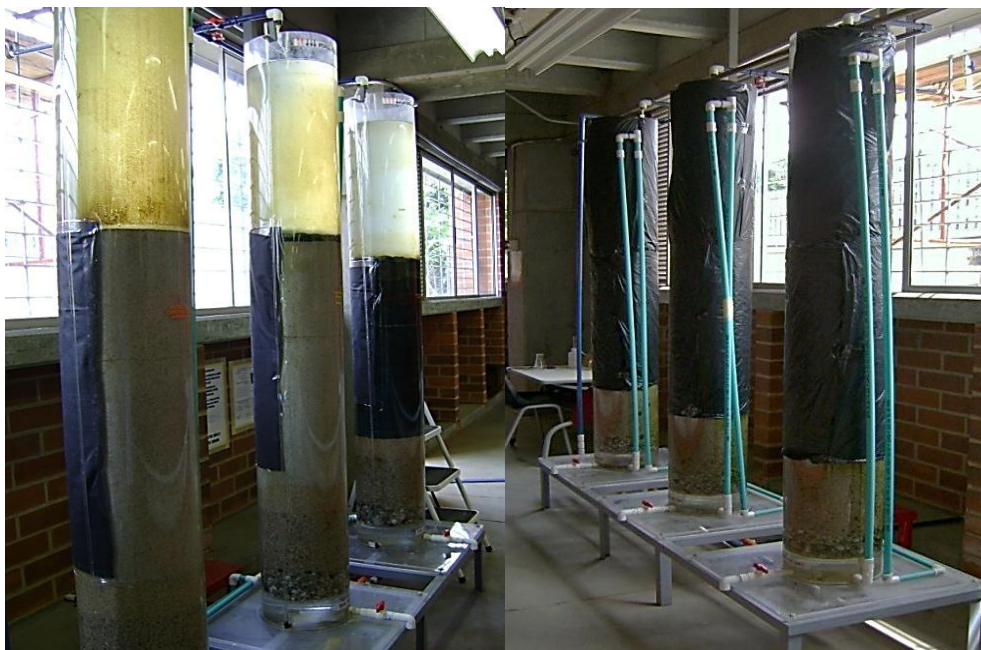
Figura 2.7. Evaluación de los sistemas de filtración a una tasa de 6m 3 /m 2 .día en presencia y ausencia de luz solar. Al lado izquierdo los sistemas de filtración trabajando en presencia de luz solar y a la derecha en ausencia de la misma.
