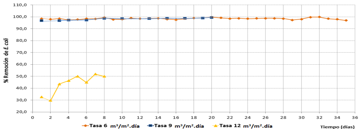
Figura 3.17. Remoción de E.coli para cada una de las tasas de filtración evaluadas en el SF2.
