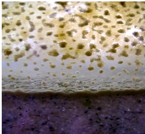
Figura 1.3. Capa biológica que se forma en la superficie del lecho filtrante de arena.
