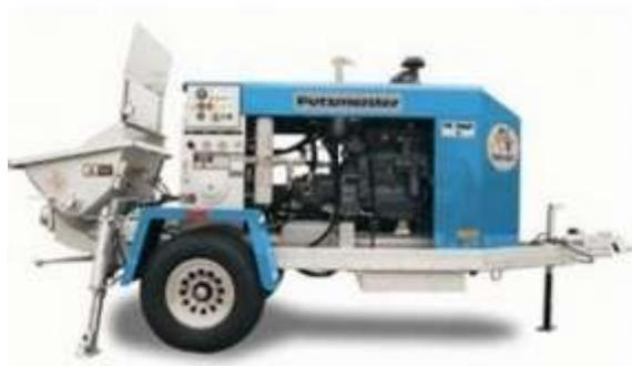
Bomba montada sobre un chasis, con uno o dos ejes sobre llantas, se debe remolcar con un vehículo y luego de estacionada y bloqueada en la obra, se le adicionan tramos de tubería rígida que son unidos mediante abrazaderas, hasta llegar al punto de descarga del concreto, al final se le conecta una manguera flexible para facilitar la descarga.
