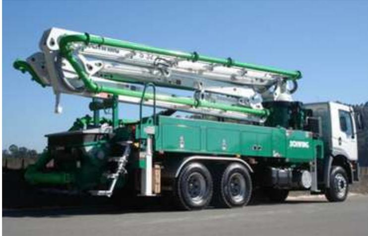
Bomba montada sobre camión que tiene adosado un brazo escualizable de secciones rígidas que puede estirarse en toda su longitud, una vez que el camión ha sido parqueado y bloqueado mediante arañas estabilizadoras, al final se le conecta una manguera flexible para facilitar la descarga. En Colombia los brazos disponibles suelen ser de 32 m a 36 m de longitud.
