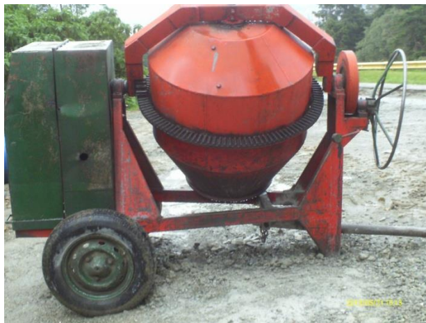
5. Mezcladora de dos sacos diesel.
