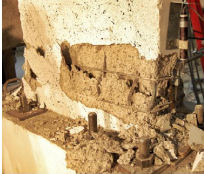
Fotografía 5-2. Pandeo del refuerzo longitudinal, adaptada de [2].
