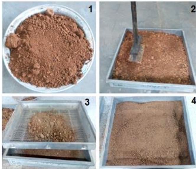
Figura 28. Proceso de secado, triturado y tamizaje del suelo. Fuente: Elaboración propia.
