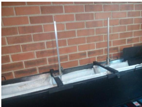
Figura 32. Sistema de medición de las profundidades de la lámina de agua. Fuente: Elaboración propia.
