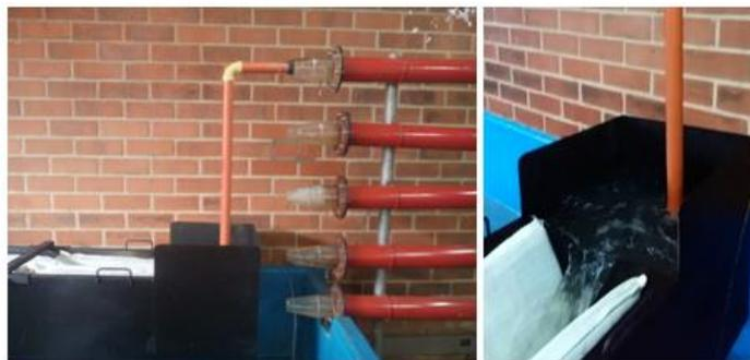
Figura 31. Sistema de chorros para proporcionar caudal a la cuneta. Fuente: Elaboración propia.
