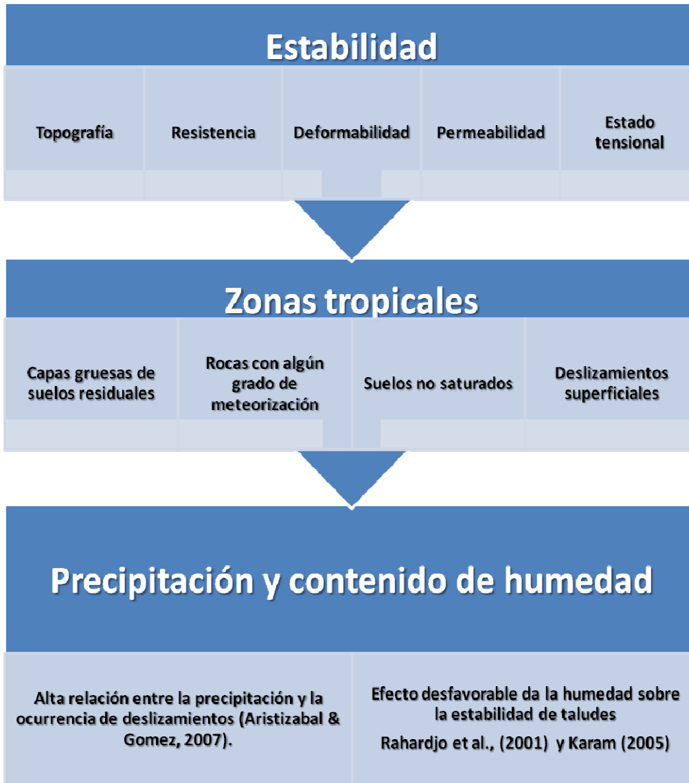
Imagen 6. Factores que afectan la estabilidad del talud.
