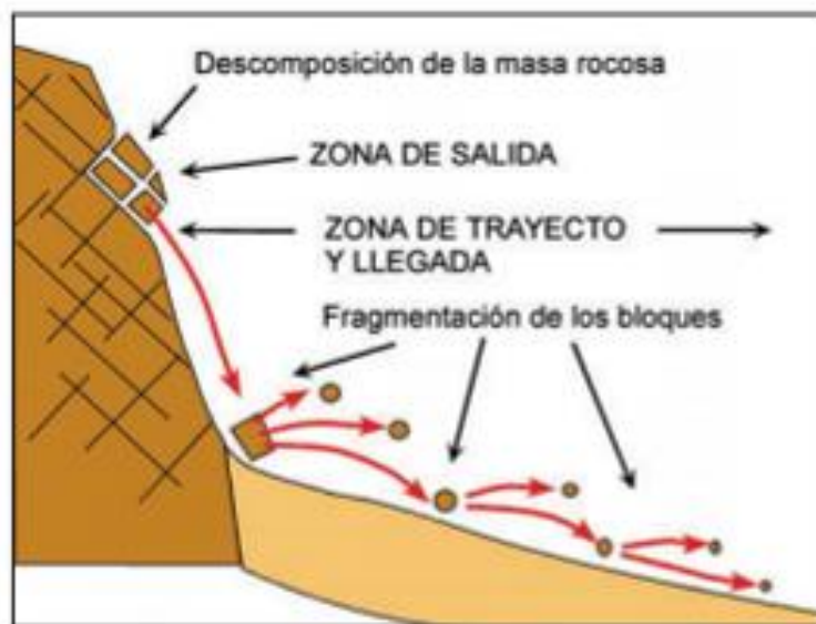
Figura 24. Esquema de un Desprendimiento
