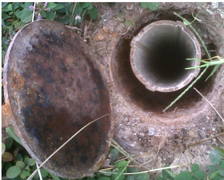
Figura 33. Tubo guía PVC para sonda inclinométrica.
