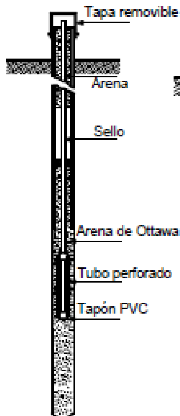
Figura 40. Piezómetro de Casagrande.
