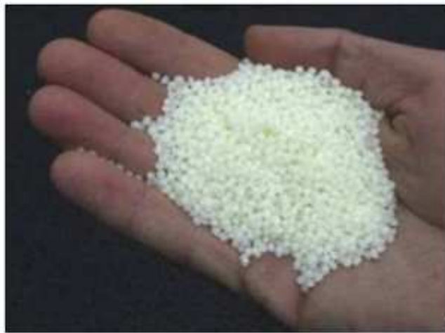
Figura 4.2. Apariencia del aditivo granulado, Sasobit.
