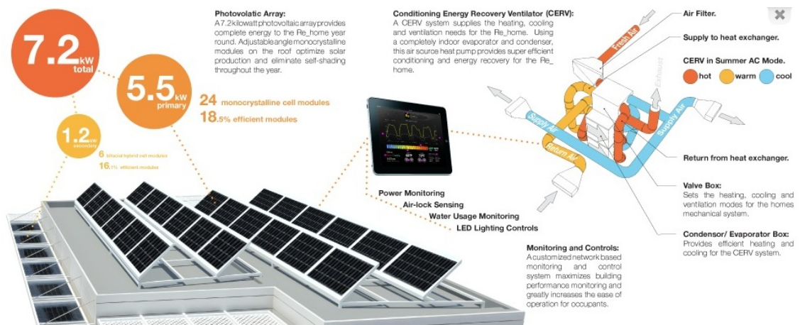
Imagen 49. Sistema de energía por paneles solares
