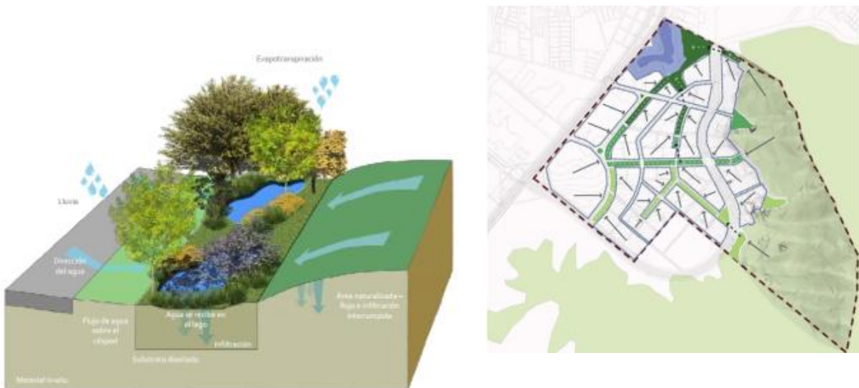
Figura 1. Esquema sobre manejo de aguas lluvias en el proyecto Maiporé Fuente: (Ciudadela Colsubsidio Maiporé)
