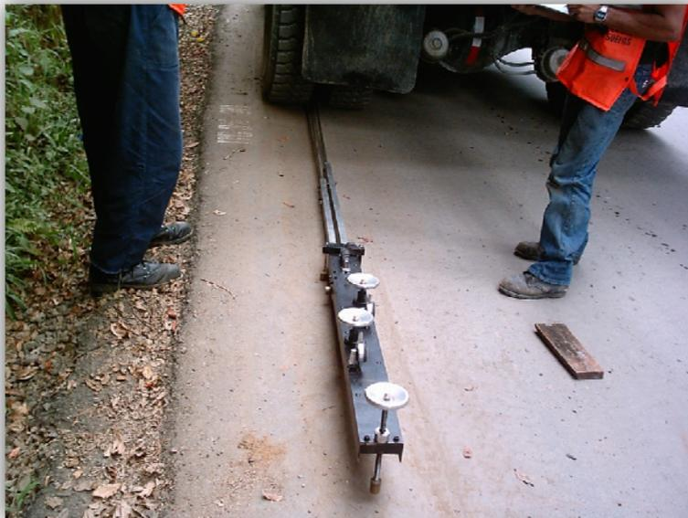
La viga Benkelman es un equipo que fue desarrollado durante el ensayo de la “Western Association of State Highway Organizations” (WASHO) en 1952. Se trata de un dispositivo bastante simple, que funciona aplicando la conocida “regla de la palanca” (Nazzal, 2003). Este método se puede considerar simple y económico y su principio de aplicación es ampliamente conocido y consiste en medir el
