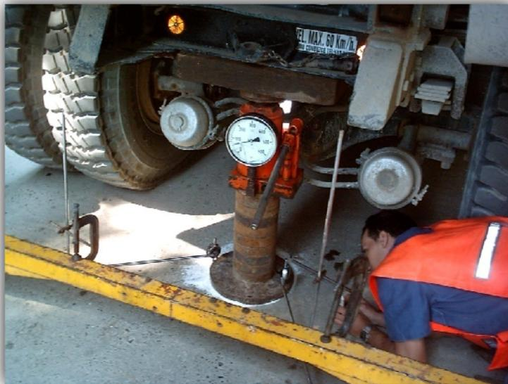
Los ensayos de placa de carga se utilizan para comprobar el módulo de deformación de capas de terraplenes y firmes. El método habitualmente utilizado es el estático, con carga aplicada sobre una placa circular mediante un gato hidráulico, utilizando un camión cargado o una máquina pesada como reacción para el gato (Tadeo, 2006).
