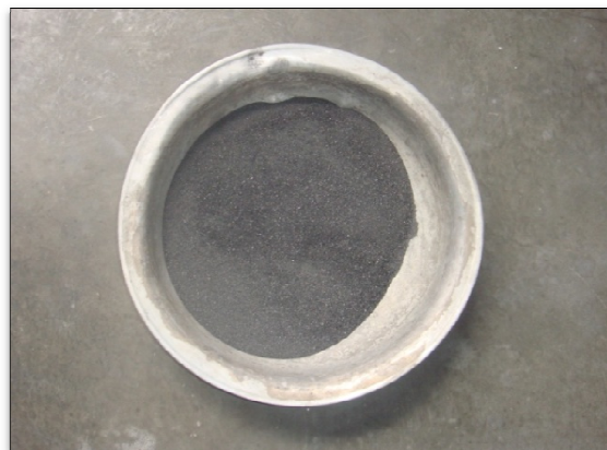
Figura 20. Ceniza extraída del multiciclón empresa textil
