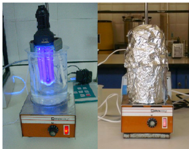
Figura 3. Montaje experimental del sistema fotocatalítico
